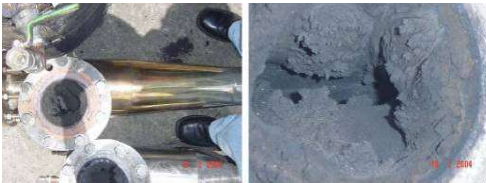
Figura 65 - Fotos da entrada do ciclone após o encerramento dos testes no IPT Fonte: USHIMA, 2004f.
