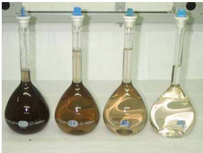
Figura 63 - Aspecto da água de lavagem antes e após o tratamento com carvão vegetal retirado do gaseificador Fonte: USHIMA, 2003c.
