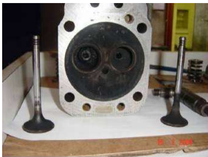
Figura 08 - Vista das válvulas e das respectivas sedes Fonte: USHIMA, 2004f.
