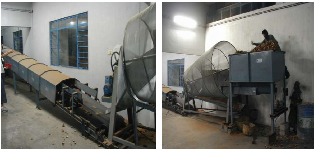
Figura 24. Equipamento responsável pela uniformização da biomassa
