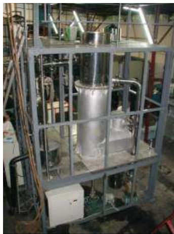
Figura 40 - Aspecto do gaseificador após montagem sobre a estrutura metálica Fonte: USHIMA, 2003c.
