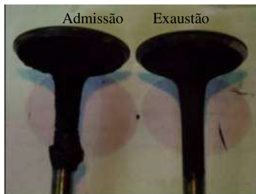
Figura 02 - Deposição de alcatrão sobre a válvula de admissão de um cilindro Fonte: USHIMA, 2004f.
