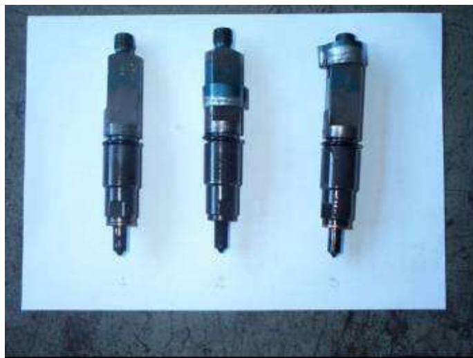
Figura 05 - Estado dos bicos ejetores de óleo diesel após 100 horas de operação com gás Fonte: USHIMA, 2004f.
