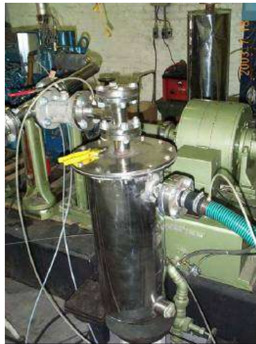
Figura 73 - Foto da parte externa do filtro de manga instalado na entrada do motor Fonte: USHIMA, 2004f.
