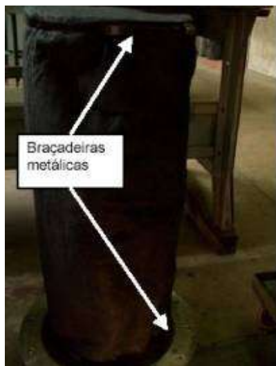
Figura 74 - Fotos das partes internas do filtro manga: filtro preso no suporte metálico (pelo lado externo do suporte) pelas braçadeiras, à esquerda, e o suporte metálico sem o filtro, à direita.
