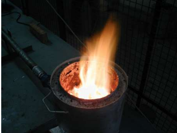
Figura 9. Gaseificador - fogão em funcionamento
