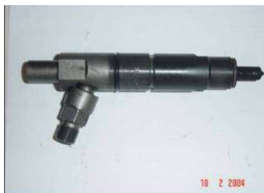
Figura 11 - Foto de um dos bicos injetores de diesel após as 100 horas Fonte: USHIMA, 2004f.
