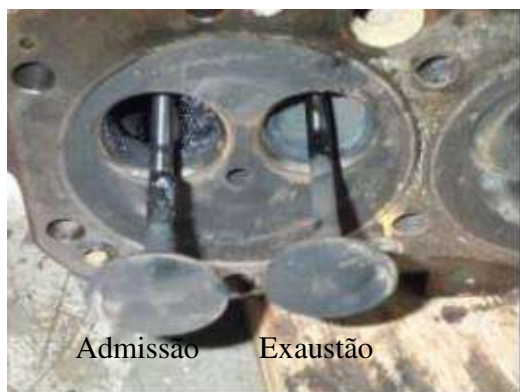
Figura 02 - Deposição de alcatrão sobre a válvula de admissão de um cilindro Fonte: USHIMA, 2004f.
