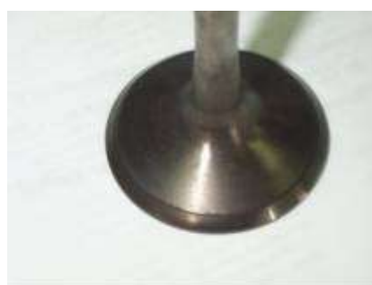
Figura 03 - Corrosão por “pit” numa das válvulas de admissão, observada após a remoção do depósito
